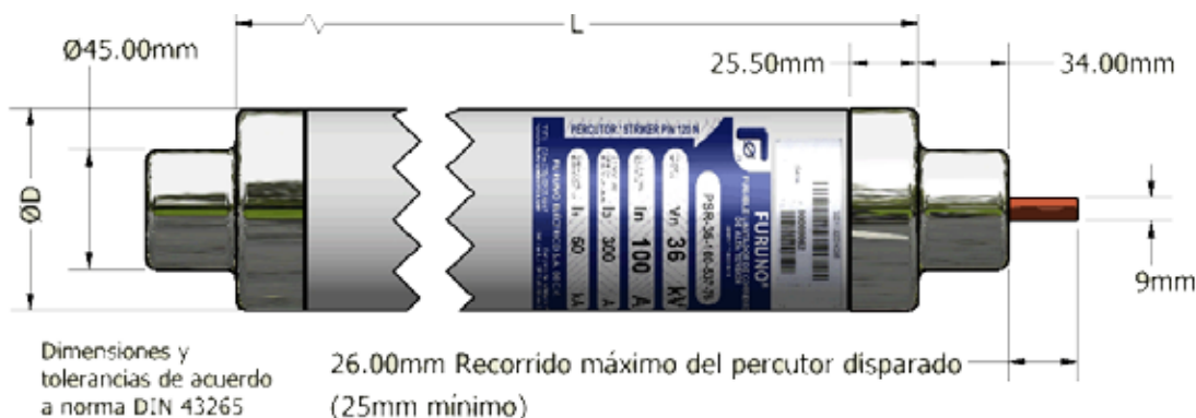
DIAGRAMA DE FUERZA-D ESPLAZAMIENTO DEL PERNO PERCUTOR DE FUSIBLES FURUNO®
